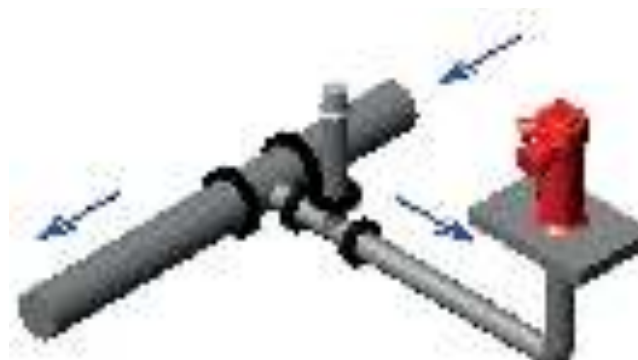
Figure 15 : Distribution de l'eau sur un PEI positionné sur un réseau ramifié
