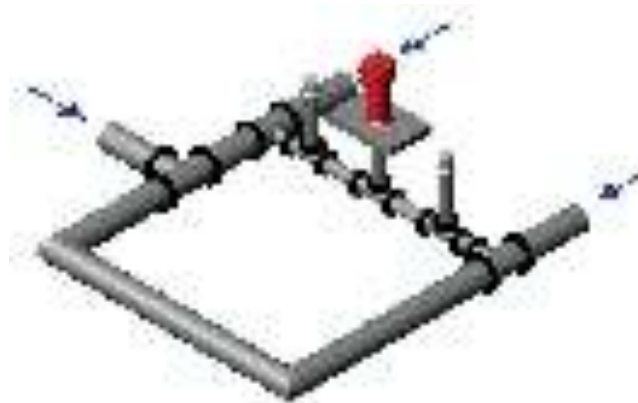
Figure 17 : Distribution de l'eau sur un PEI positionné sur un réseau maillé
